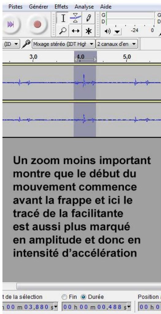
Figure Acc.27 : Zoom de l'ensemble du mouvement
